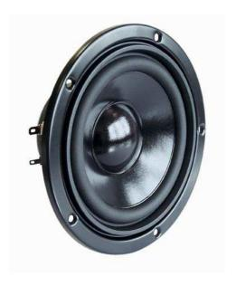
**13 cm (5") HiFi Tiefmitteltöner** mit beschichteter Papiermembran, elastischer Gummisicke und 25-mm-Schwingspule. Einsetzbar als Tieftöner und durch sehr ausgeglichenen Frequenzgang auch als Tiefmitteltöner in größeren 3-Wege-Boxen.
