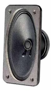
7 x 13 cm (2,8" x 5") Breitbandlautsprecher mit hohem Wirkungsgrad und Hochtonanstieg für gute Sprachverständlichkeit. Geeignet für den Einsatz in schmalen Lautsprecherzeilen, für Beschallungsanlagen und ELA-Systeme in 100-V-Technik.
