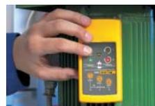
Détection du sens de rotation des moteurs par simple pose sur le boîtier du moteur
