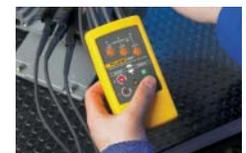
Vérification de la rotation des moteurs avant le branchement
