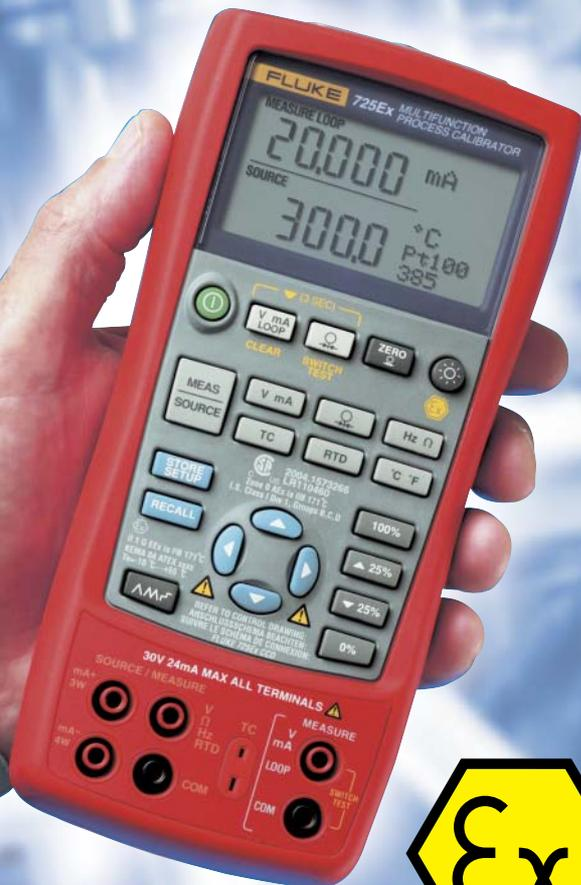
Il nuovo calibratore di processo multifunzione a sicurezza intrinseca Fluke 725Ex è uno strumento potente e semplice da usare. Utilizzato in combinazione con i nuovi moduli di pressione Fluke 700PEX, il modello 725Ex consente di calibrare quasi tutti gli strumenti di processo impiegati in aree in cui possono essere presenti gas esplosivi.
