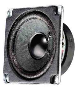
**5 cm (2")** Breitbandlautsprecher mit quadratischem Korb, weicher Sicke und leichter Spezialmembran. Ausgeglichener Frequenzgang ab 250 Hz und spritzige Hochtonwiedergabe mit gutem Rundstrahlverhalten. Geeignet als Mitteltöner in Lautsprecherzeilen für HiFi- und Beschallungsanlagen sowie für ELA-Systeme in 100-V-Technik. Durch die geringen Abmessungen auch sehr gut für den Modellbau und als Kontrolllautsprecher in elektronischen Geräten geeignet.
