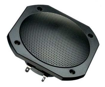
Seewasserbeständiger 10 cm (4") Breitbandlautsprecher mit Glasfasermembran, Kunststoffkorb und Kunststoffgitter. Ausgeglichener Frequenzgang, hoher Wirkungsgrad und gute Mittel-Hochtonwiedergabe. Durch dauerhafte Wetterfestigkeit besonders geeignet für Außenbeschallungsanlagen, Schwimmbäder, Saunen und als Einbaulautsprecher für Boote, Schiffe und offene Fahrzeuge. Auch als Einbaulautsprecher für Schiffs- und Bootsmodelle.
