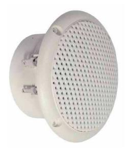
Seewasserbeständiger 8 cm (3,3") Breitbandlautsprecher mit gespritzter Kunststoffmembran sowie Kunststoffkorb und -gitter. Absolut korrosions- und wasserfest durch Magnetverkleidung und Silikonummantelung der Zuleitung. Klare Hochtonwiedergabe.
