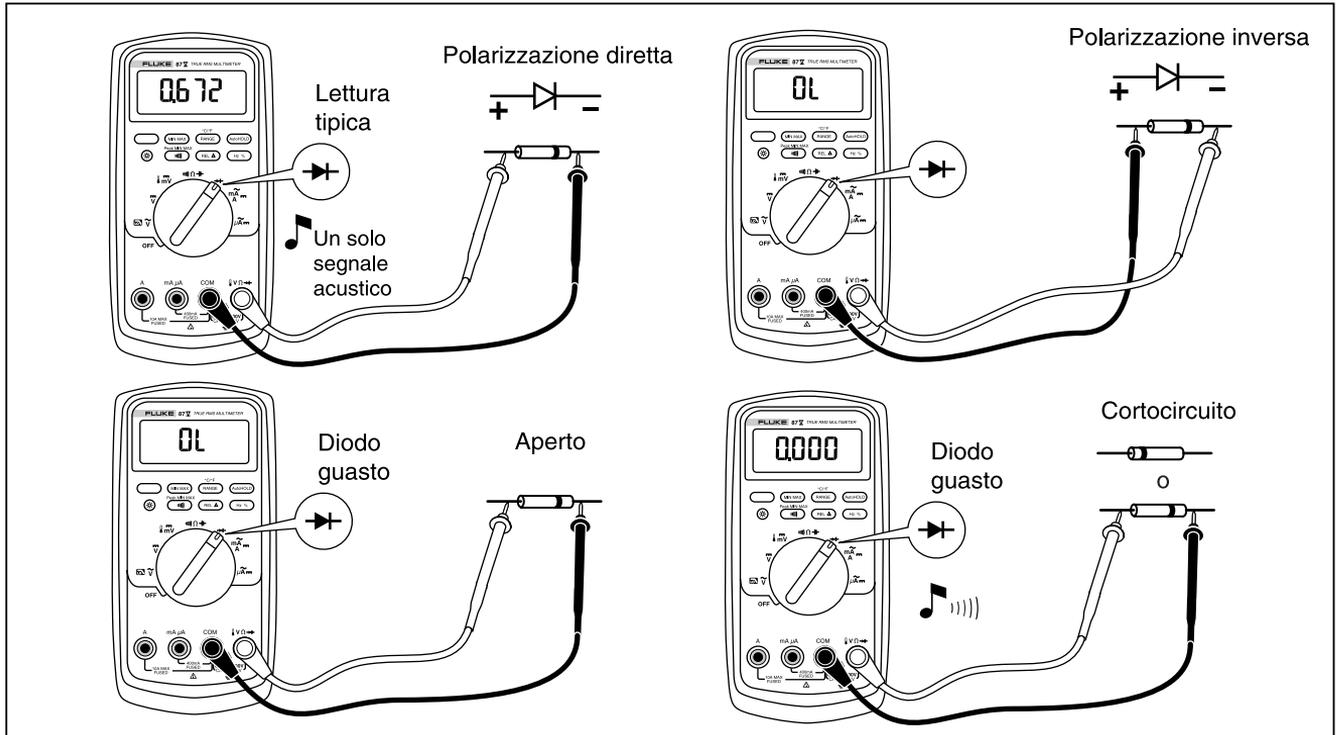
Figura 7. Prova di un diodo
