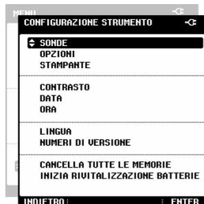
Selezionare la sensibilità della sonda di corrente che si deve usare sull'ingresso 2. Per tutte le applicazioni della Guida alle applicazioni, usare la sonda di corrente i400s e scegliere **1 mV/A**.
