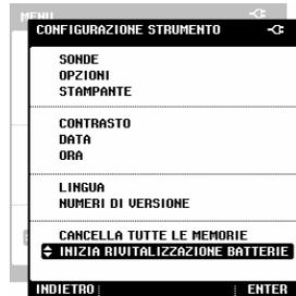
Accertare che il Fluke 43B sia alimentato con l'adattatore di corrente.
