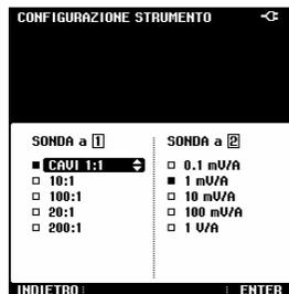
Selezionare il tipo di sonda che si deve usare sull'ingresso 1. Per tutte le applicazioni della Guida alle applicazioni, si devono usare i cavi prova 1:1.
