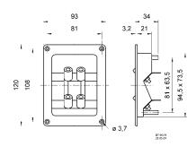
**Doppelanschlussterminal** mit vergoldeten Schraubklemmen und Kurzschlussbügeln, aus Messing vergoldet, zum Betrieb von Bi-Wiring oder Bi-Amping. Mit vier Stegen zur Befestigung einer Platine. (Terminal ist mit Blindstopfen versehen.)
