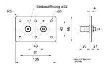
**High-End Terminal** mit stabiler Montageplatte und extrem hochwertigen, 5-Schicht-supravergoldeten WBT-Klemmen mit frei drehbarem Anschlussdruckstück. Für Anschlussleitungen mit einem Querschnitt von 1,5 bis 10 Quadratmillimetern, die bei Spitzenströmen bis zu 200 A einen sicheren Kontakt garantieren.
