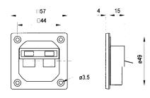
**Lautsprecher-Anschlussklemme** mit versenkt angebrachter Klemmleiste und Schaumstoffdichtung zum luftdichten Einbau. Für Kabelquerschnitte bis 10 mm², 2-polig, je 1 roter und 1 schwarzer Druckhebel. Runde Ein- bauöffnung. Inkl. Schrauben zur Befestigung.
