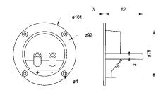
**Rundes Schraubterminal** mit vergoldeten Anschlüssen und zwei Halterungen zur Aufnahme einer Platine.
