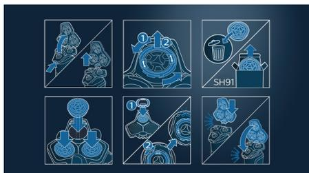
1. Appuyez sur les boutons de déverrouillage et retirez le support des têtes de rasage. 2. Retirez les bagues de fixation en les tournant dans le
