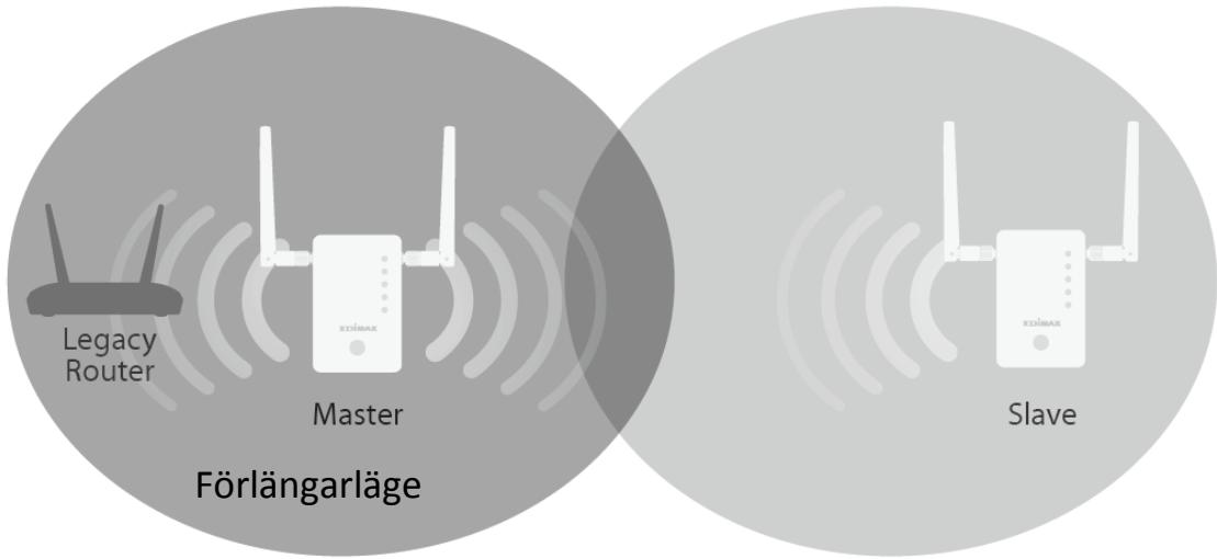
Varje RE11S kan fungera i ett av tre lägen. För att använda roaming, ställ in din **master-förlängare** i läget **Wi-Fi förlängare** eller **Wi-Fi åtkomstpunkt**.
