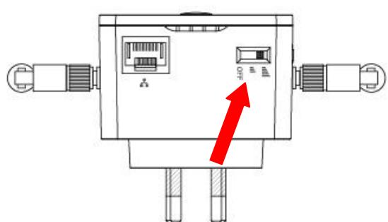
Om du använder förlängaren på en plats som är liten eller mellanstor kanske du inte behöver full effekt för den trådlösa radion. Testa och avgör om du fortfarande har tillräcklig W-Fi täckning med grönt läge. Om så är fallet kan du spara en del energi.
