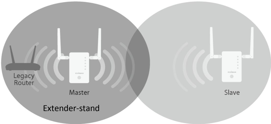
Elke RE11S kan functioneren in drie verschillende standen. Wilt u roaming gebruiken, dan stelt u uw **master**-extender in in de stand **Wi-Fi Extender** of **Wi-Fi Access Point**.
