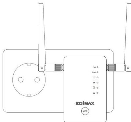
2. The **grønne** power LED **blinker**, mens extenderen starter. Enheden er parat, når den **grønne** power LED viser **tændt**.
