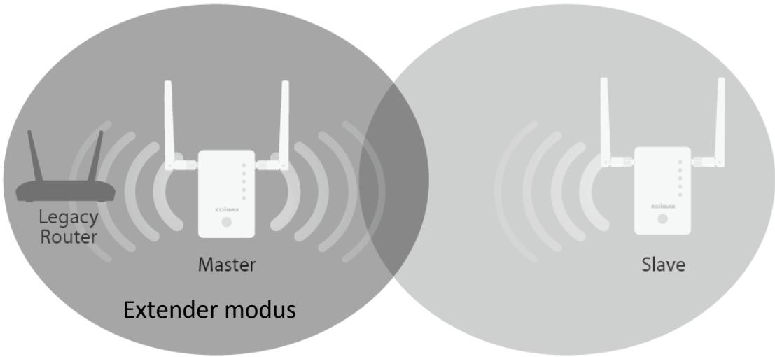
Hver enkelt RE11S kan fungere i en af tre modi. For at kunne anvende roaming skal din **master** extender indstilles på modus **wi-fi extender** eller **wi-fi adgangspunkt**.
