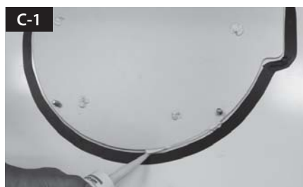
Breng siliconenkit aan rondom de bevestigingsplaat
