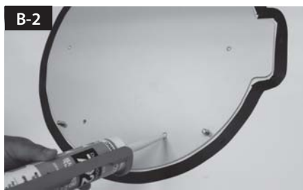
Spuut siliconenkit in de gaten
