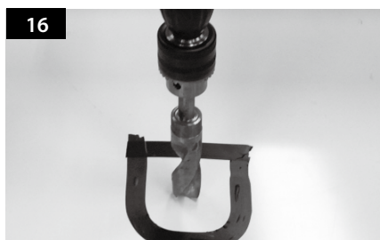
Bohren Sie ein 15mm Loch in die Mitte der mit Isolierband markierten Fläche.
