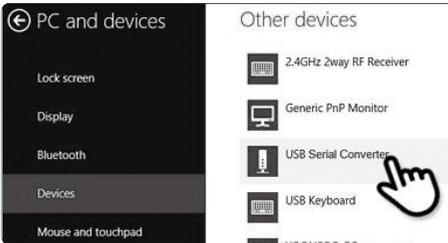
01. Verbinden Sie das USB-Kabel und schalten Sie den Controller ein. Bitte überprüfen Sie ob der [USB Serial Converter] Port am [PC und Gerät] aktiviert wurde.
