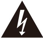
Символ в виде молнии, заключенной в треугольник, используется для предупреждения пользователя о наличии внутри корпуса устройства неизолированного источника «опасно высокого напряжения», которое может стать причиной поражения электрическим током.
