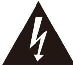
En trekant med et lynsymbol tiltrækker brugerens opmærksomhed til "farlig strømspænding" uden isolering som kan være stærk nok til at give et elektrisk chok.
