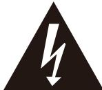
Un triángulo con un símbolo de rayo con punta dentro de un triángulo tiene el propósito de alertar al usuario de la presencia de voltaje "peligroso" no aislado dentro de la caja que puede ser de suficiente magnitud para constituir un riesgo de descarga eléctrica a los seres humanos.
