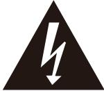
Der Blitz im gleichseitigen Dreieck weist auf gefährliche Hochspannung im Gerät hin, die zu Stromschlag führen kann.
