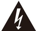
Şimşek simbolüne sahip bir üçgen kullanıcının dikkatini kabinde yalıtmış olmadan elektrik çarpması tehlikesine neden olmaya yeterli "tehlikeli voltaja" çeker.
