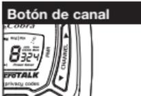
Con la radio encendida (**on**), seleccione uno de los 8 canales pulsando los botones **Channel Up** (canal siguiente) o **Channel Down** (canal anterior).
