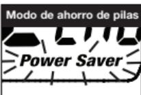
Si no se produce ninguna transmisión durante 10 segundos, la radio pasará automáticamente al modo **Battery Save** (ahorro de pilas) y el icono **Power Saver** (ahorro de energía) parpadeará en la pantalla. Esto no afectará la habilidad de la radio para recibir transmisiones entrantes.
