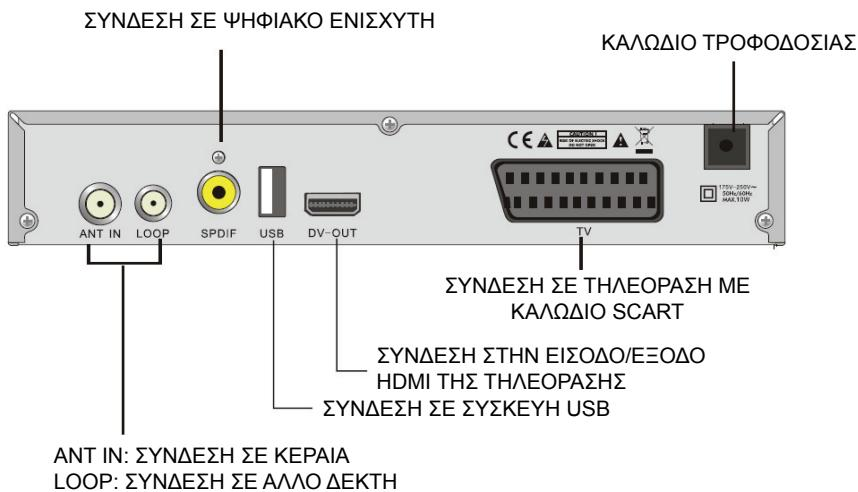
Σύνδεση σε τηλεόραση με υποστήριξη SCART:
