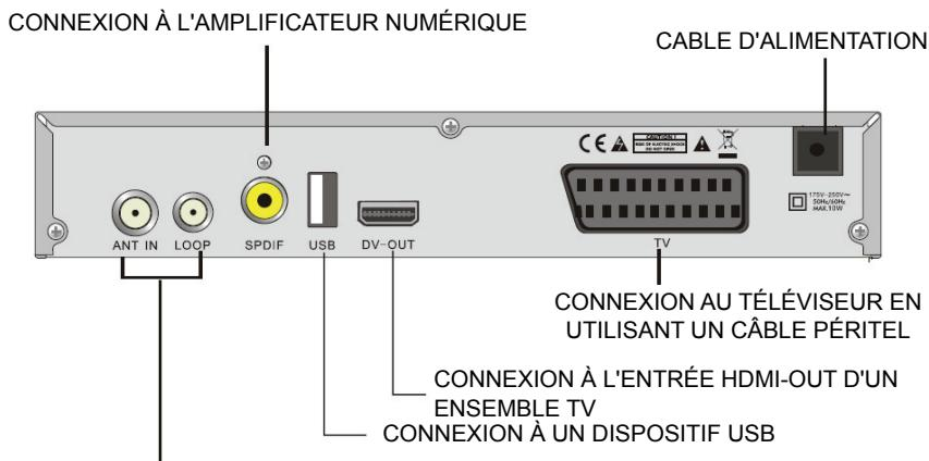
ANT IN (ENTRÉE D'ANTENNE) : CONNEXION À L'ANTENNE
