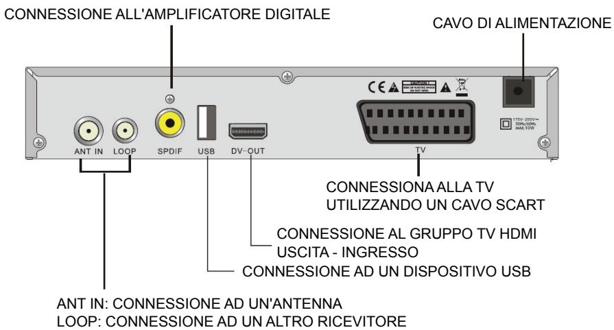
Connessione ad una TV utilizzando un supporto SCART:
