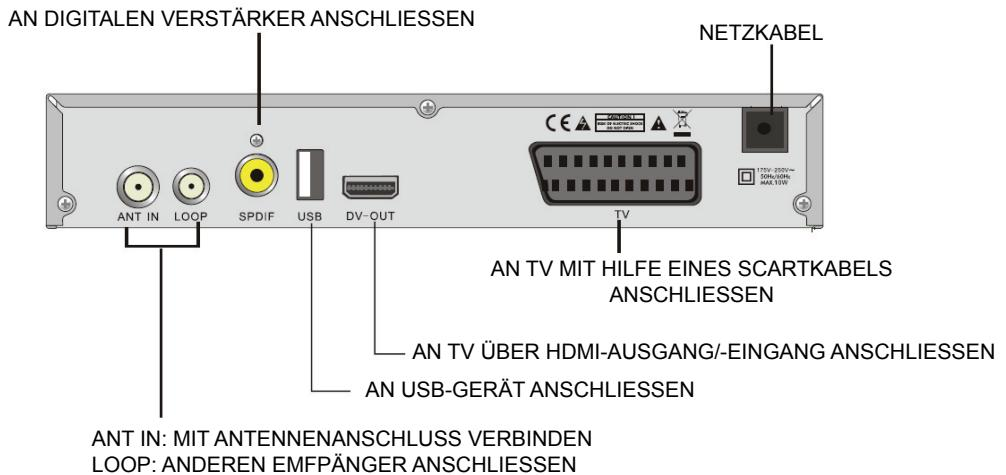
**Anschluss an TV über Scart-Anschluss:**
