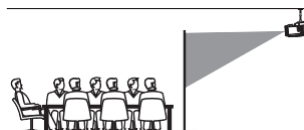
PLAFOND À L'ARRIÈRE
