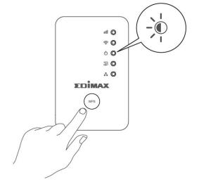
2. Attendere il riavvio dell'unità di estensione. L'unità di estensione è pronta per la configurazione quando il LED di alimentazione verde visualizza acceso.
