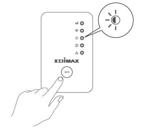
**2.** Espere a que el extensor se reinicie. El extensor está listo para configurar cuando el LED verde de alimentación está encendido.
