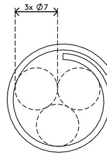
Addit bobina mangiacavo  $\varnothing 15$  mm / 3 m & utensile inseritore 733
