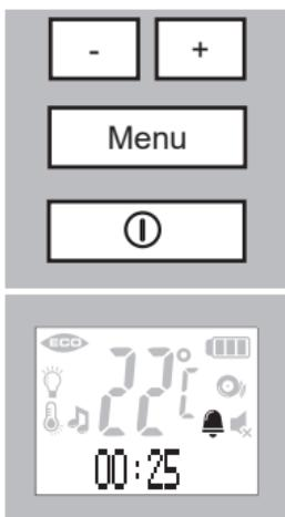
3. Drücken Sie **MENU** +/-, um zwischen [ EIN-MAL? ] (einfacher Alarm) oder [ WIEDERHOLEN? ] (wiederholter Alarm) zu wählen.
