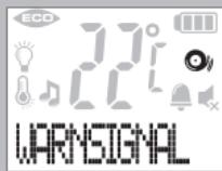
Nach der Aktivierung des Geräuschalarms wird der Text [ WARNSIGNAL ] angezeigt, das Symbol blinkt und es sind drei Pieptöne zu hören.
