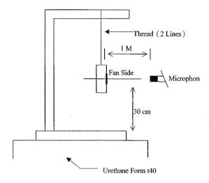
1 METER FROM MICROPHONE TO FAN INTAKE
