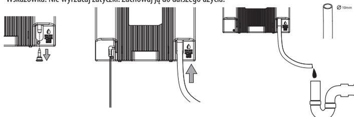
**Uwaga:** Po podłączeniu rurki drenażowej wysunięcie zbiornika z urządzenia jest niemożliwe. Odłącz rurkę zanim spróbujesz wysunąć zbiornik.
