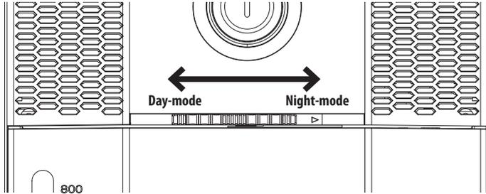
**Talvitila/normaali tila:** Talvitilaa voidaan käyttää paremman suorituskyvyn saavuttamiseksi kylmissä ympäristöissä ja se voidaan aktivoida painamalla laitteen takana olevaa liukusäädintä. Talvitilaa on käytettävä vain, kun ympäristön lämpötila on <15 °C. Käytä normaalitilaa, kun lämpötila on >15 °C. Talvitilan käyttäminen >15 °C lämpötiloissa alentaa suorituskykyä.
