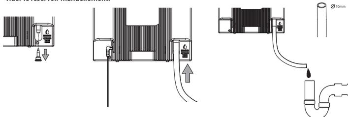
**Avvertissement :** lorsque le tuyau de drainage est mis en place, il n'est plus possible d'extraire le réservoir de l'appareil. Vous devez ôter le tuyau de drainage avant de retirer le réservoir.
