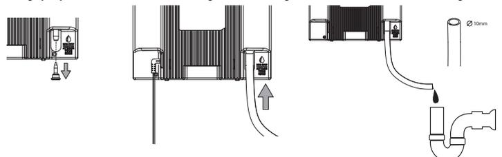
**Let op:** Wanneer u een afvoerslang gebruikt kunt u de tank niet meer uit het apparaat trekken. Maak het slangetje voor u de tank uit het apparaat trekt eerst los.
