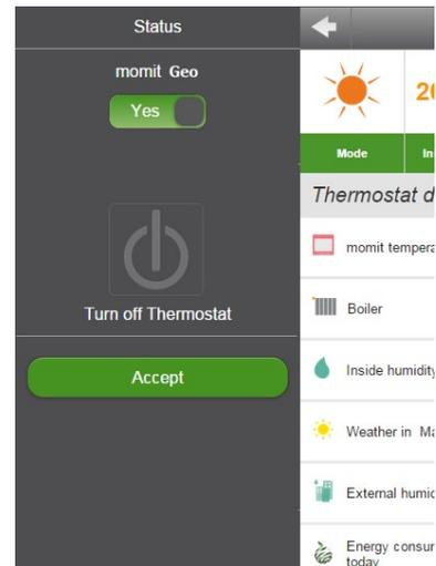
Se in modalità "Geo" si preme la relativa icona, appare un display da cui è possibile disattivare tale modalità e tornare allo stato precedente o spegnere il termostato.
