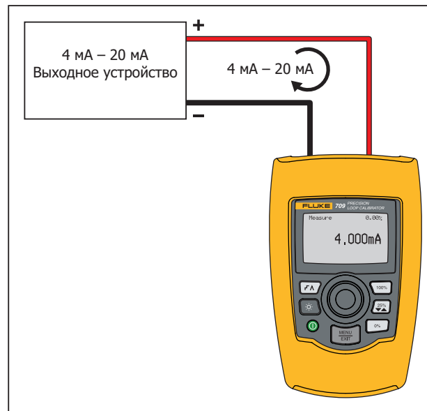
Рисунок 6. Соединения для измерения тока
