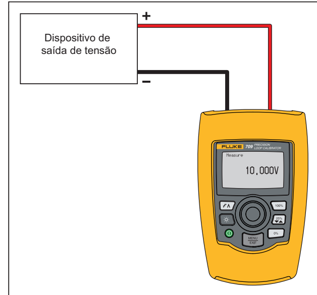
Figura 8. Conexões de Volts Measure (Medição de Volts)
