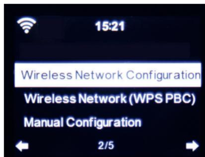
Utilisez les touches ▼▲ pour sélectionner l'option de menu requise et confirmez en appuyant sur **ENTER (ENTRÉE)**. Le réseau sera configuré conformément au point 6.4.
