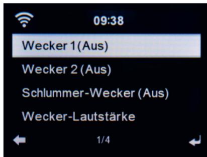
In diesem Menüpunkt können Sie bis zu 2 Weckzeiten einstellen. Außerdem kann hier eingestellt werden, ob der Wecker im Alarmfall mit einem Ton, einer Melodie oder einer Internetradiostation weckt.
